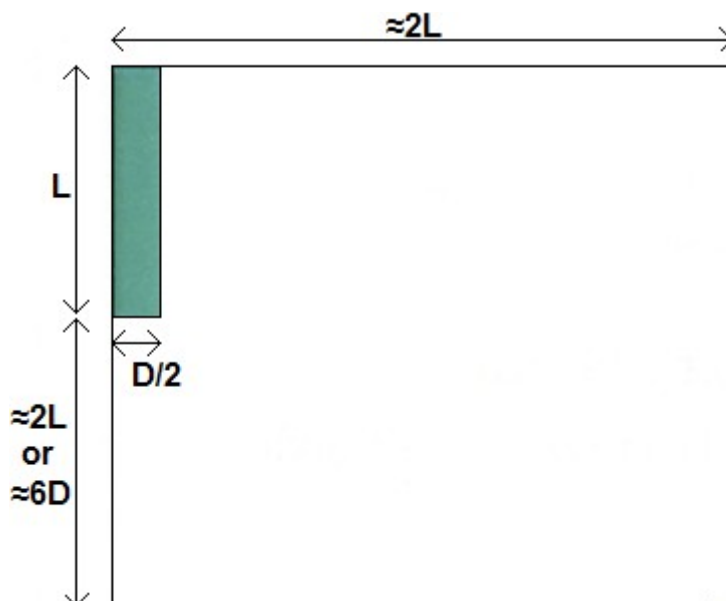
Coordenadas globales recomendados (límites) - profundidades y pilotes cimentación
