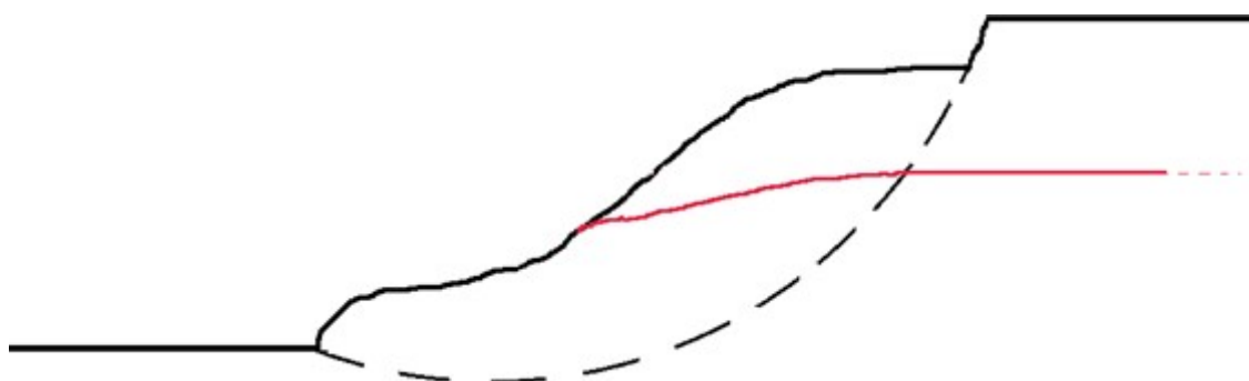
Retirada del refuerzo detrás de la superficie de deslizamiento - tipo de fallo 2
