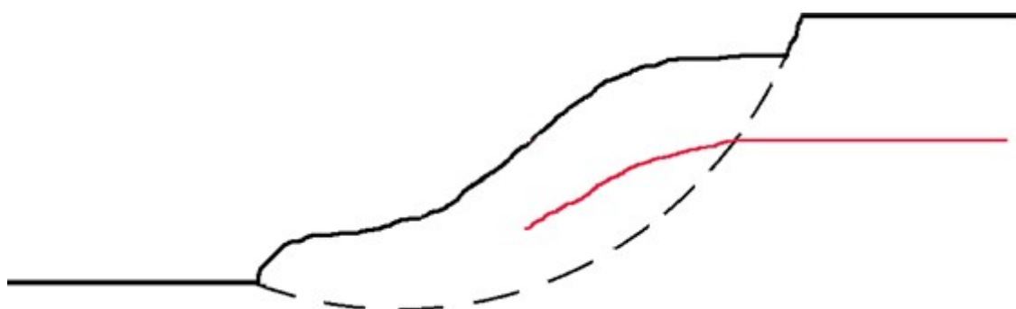
Retirada del refuerzo en frente a la superficie de deslizamiento - tipo de fallo 3
